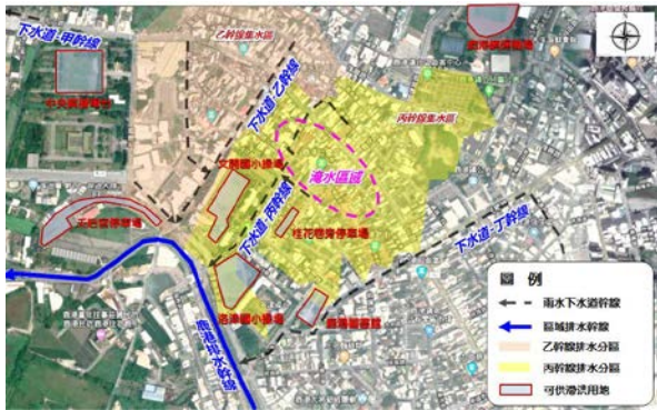
圖 6 雨水下水道丙系統淹水區域週邊可供滯洪用地位置示意圖
