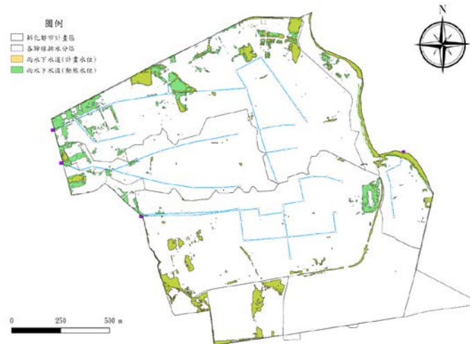
(b)、雨水下水道模型(計畫水位與動態水位)差異
