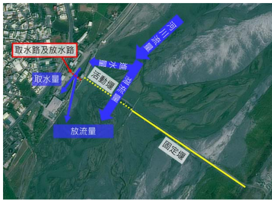
圖 5 高屏堰流量量測位置及流量關係圖
