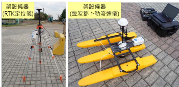
圖 6 ADCP 儀器架設作業圖
