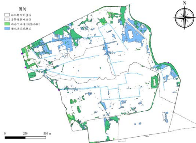
(c) 流域與雨水下水道模型(動態水位)差異
